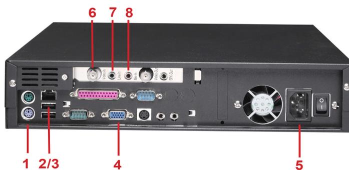
1. PS/2 MOUSE 2. Ethernet 3. USB×2 4. VGA 5. Conector de alimentación
