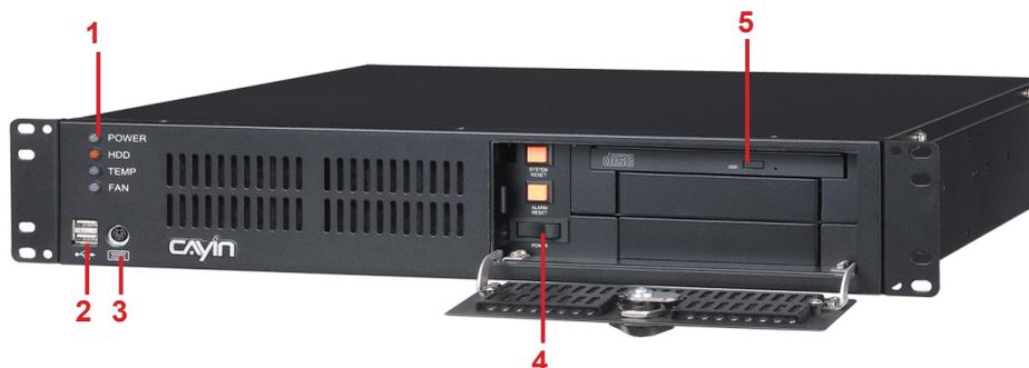
1. 電源及硬碟指示燈 2. USB x 2 3. PS/2 4. 電源開關 5. 光碟機
