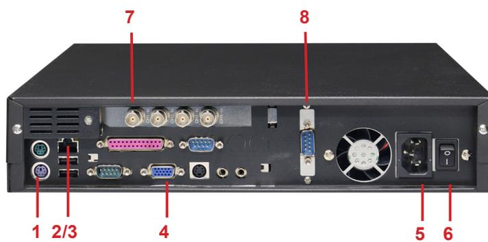
1. PS/2滑鼠    2. 乙太網路連接埠    3. USB x 2    4. VGA    5. 電源接頭
