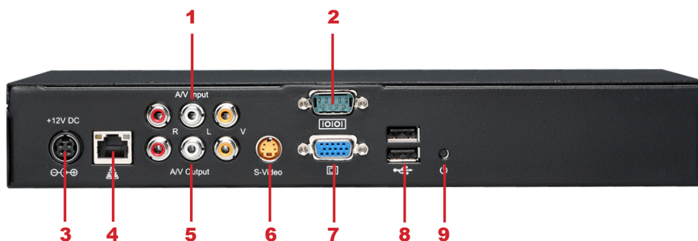
1. AV-In 2. RS-232 3. 电源接孔 4. 以太网网络接孔 5. AV-Out 6. S-Video Out 7. VGA接孔 (输出) 8. USBx2 9. 电源开关
