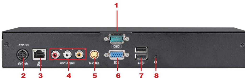
1. Port COM 2. Connecteur alimentation 3. Ethernet 4. Sortie audio
