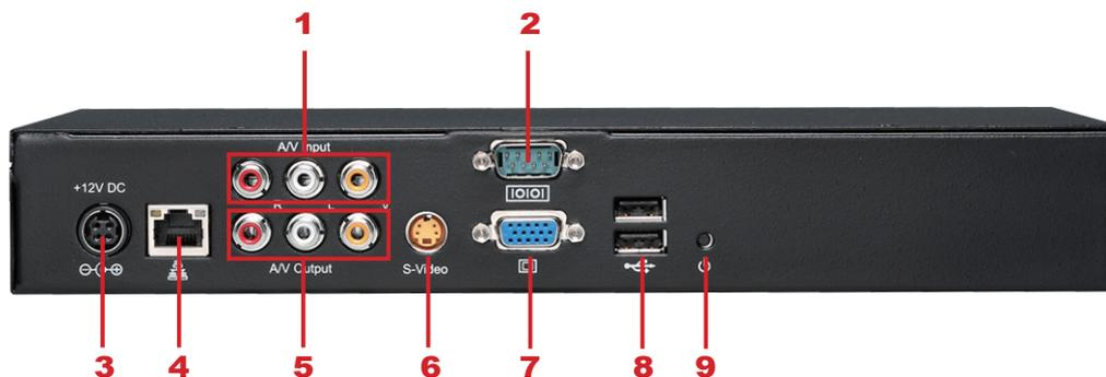
1. Entree AV 2. Port COM 3. Connecteur alimentation 4. Ethernet 5. Sortie audio
