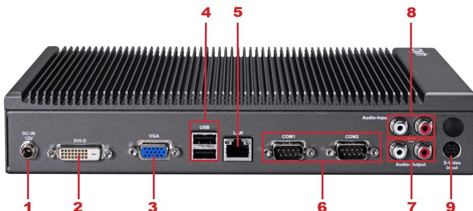
1. Conector de alimentación 2. DVI 3. VGA 4. USBx2 5. Ethernet LAN
