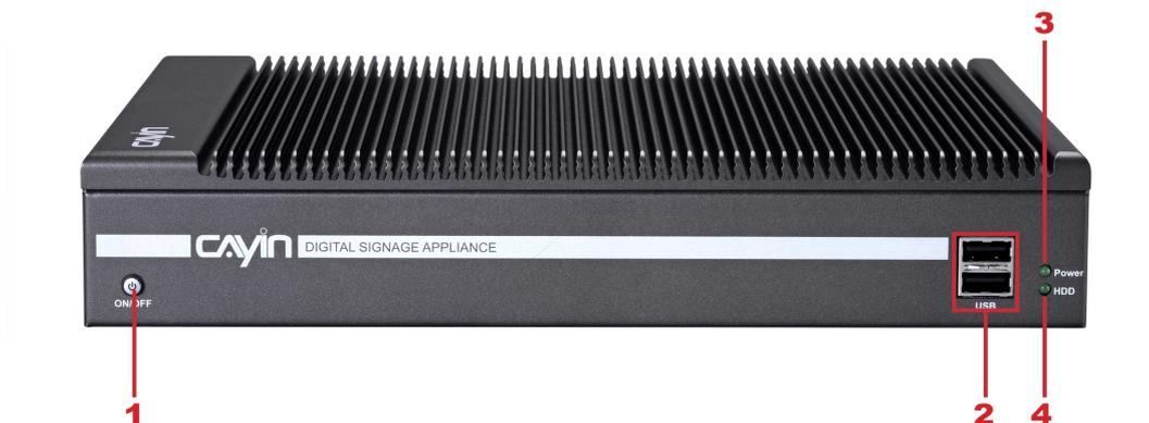
1. Encendido 2. USBx2 3. Indicador de encendido 4. Indicador de disco duro
