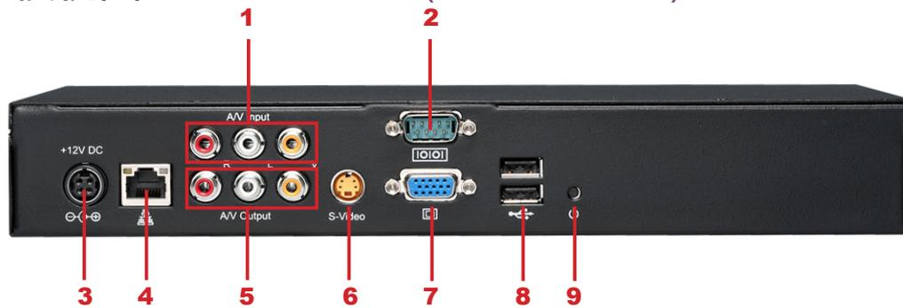
1. AV-In 2. RS-232 3. 電源接孔 4. 乙太網路接孔 5. AV-Out
