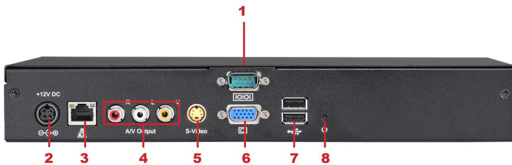
1. RS-232 2. 電源接孔 3. 乙太網路接孔 4. AV-Out
