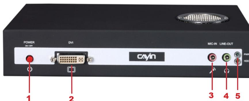
1. 電源按鍵 2. DVI接孔 3. MIC-IN (預留) 4. Audio-Out 5. 電源/硬碟指示燈
