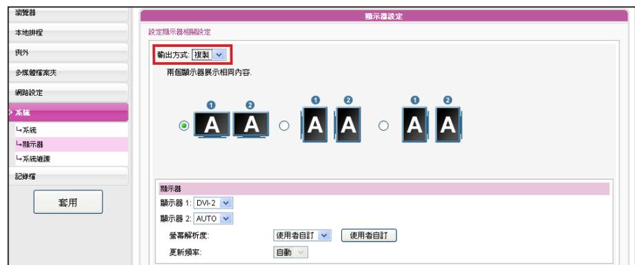
影片解析度及規格會因輸出的方法不同而有所差異，最高支援到 1080p (1920x1080)，位元率最高到20 Mbps (MPEG2)、10~12 Mbps (MPEG4)、8~10 Mbps (WMV)、5~8Mbps(H.264,僅720p ) [橫式、25 fps、單一影片]。
