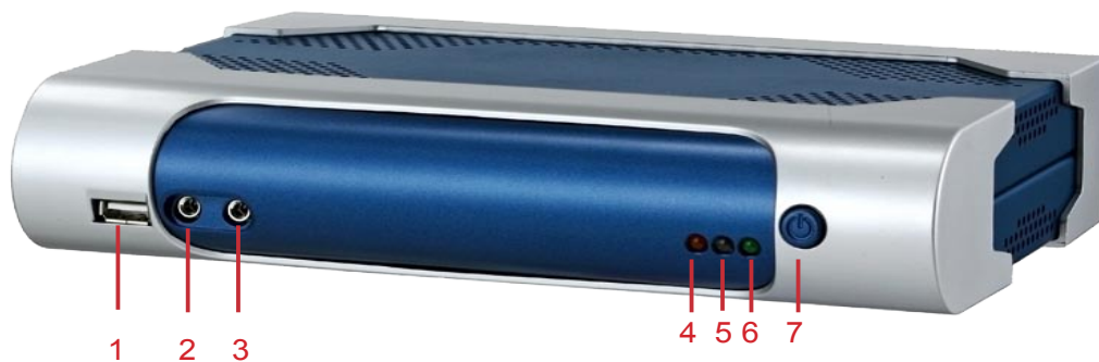
1. USB 2. Mic In 3. Audio Out 4. 網路指示燈 5. 硬碟指示燈 6. 電源指示燈 7. 電源開關
